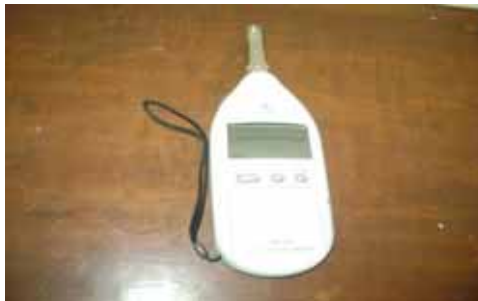
Gambar 4.8. Sound Level Meter Sumber : Dishubkominfo Kabupaten Sleman
